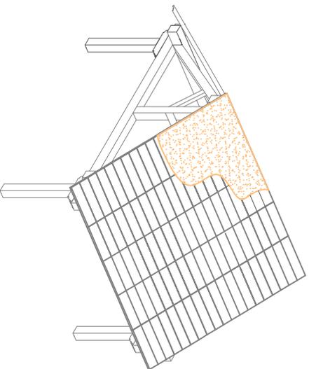
4-Se realizará una capa de compresión para una mayor unión de las placas y para la posterior colocación del acabado. En este caso será una teja cerámica curva.
