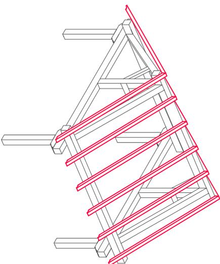
2-Colocación de las pérgolas transversales para la posterior colocación de las placas.
