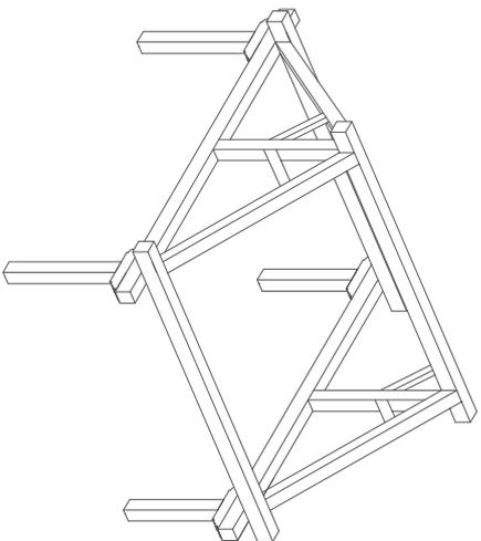
1-Montaje de la estructura de cercha sobre las columnas y capiteles. La cercha podrá tener una dimensión entre 4.00 y 7.00m
